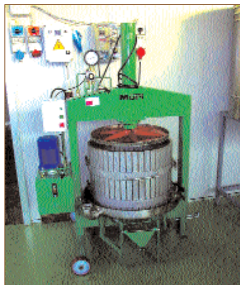
Pressa vinaria modificata appositamente per l'apicoltura della ditta Mori di San Casciano (FI)
