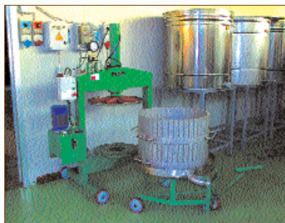
Pressa vinaria modificata appositamente per l'apicoltura della ditta Mori di San Casciano (FI)
