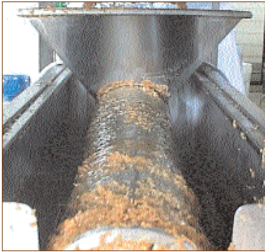
Il truciolo di cera asciutta in uscita dalla spremiopercoli Cosminox
