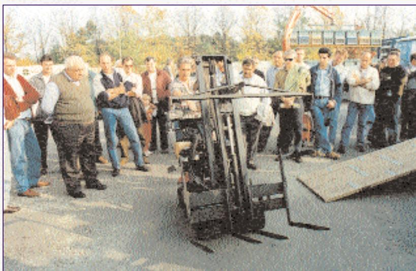
che viene utilizzato in abbinamento ad un camion cassonato di 5.30 metri di lunghezza e 40 quintali di portata. Il mezzo è montato su un motore Honda Hp 400 a benzina, pesa intorno ai 350 kg e solleva fino a 2 metri di altezza non più di 2 q.li, che equivalgono a 4 alveari senza melario.
